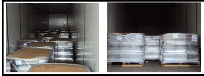
Figura 11 Acomodo correcto de los acumuladores usados dentro de las unidades de transporte
