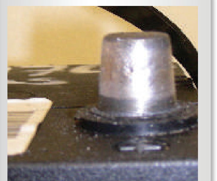
MODIFICADO Cuando se reconstruye un poste para ocultar algún daño.
