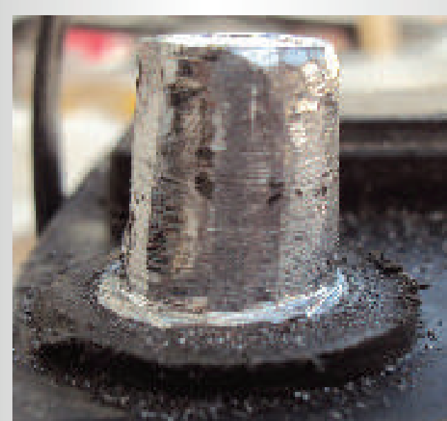
LIMADO Limar el poste para ocultar algún daño.
