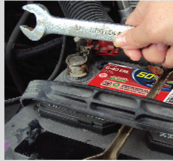
CORTO PROVOCADO Por unir los postes con algún objeto metálico para comprobar carga o que los postes hagan contacto con el cofre.
