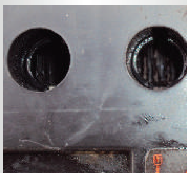
BAJO NIVEL DE ELECTROLITO Provocado por sobrecargas y/o aplicación incorrecta.
