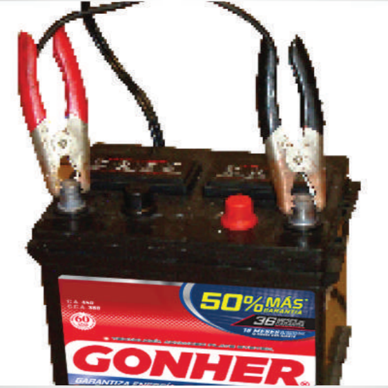
POLARIDAD INVERTIDA Recargar la batería con polaridad invertida e instalar de nuevo, causa daños al sistema eléctrico.
