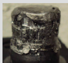
APRETADO Por utilizar terminales inadecuadas o usar terminal negativa en poste positivo.
