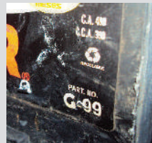
RASPADA Por no estar bien sujeta a su base.
