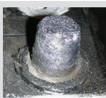
FUNDIDO Ocurre cuando se provoca un corto para comprobar carga.
