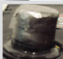
DOBLADO Ocurre al golpear el poste o terminal con algún objeto o por levantar con pinzas.
