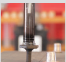
MATERIAL NEGATIVO DESPRENDIDO Desprendimiento de material por exceso de vibración, por no estar fija o haber recibido sobre descargas.
