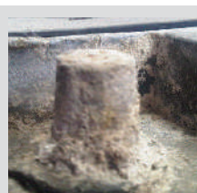
SULFATADO Ocasionado por un golpe.
