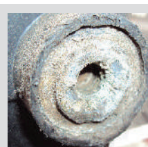
DAÑADA Por golpes o falso contacto en la conexión.
