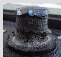
GOLPEADO Golpes directos o al golpear el poste cuando no se abre correctamente la terminal.
