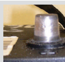
MODIFICADO Cuando se reconstruye un poste para ocultar algún daño.
